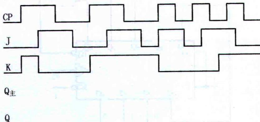
七、分析下列电路，说明其电路类型，写出电路的状态转移方程，状态转移表，画出电路的状态转换图，说明该电路功能。（20分）
