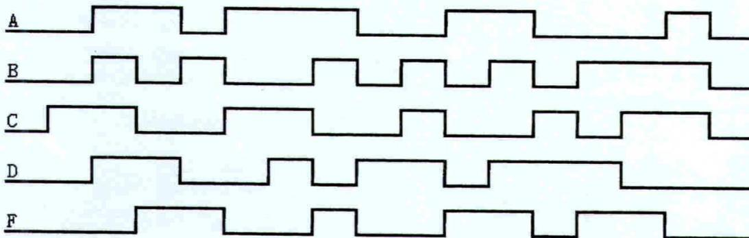
四、二—十进制译码器 74LS42 的真值表如下表所示，写出下图所示函数  $F_1$ 、 $F_2$  的表达式，并画出它们的波形图。（20 分）
