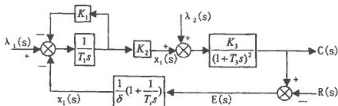
当系统的给定值不变( $r(t)=0$ )时，试求在扰动量  $\lambda_1(t)=a_1 \cdot l(t)$  和  $\lambda_2(t)=a_2 t$  同时作用于系统时，被调量  $c(t)$  的静态偏差值  $e(\infty)$ 。(15分)
