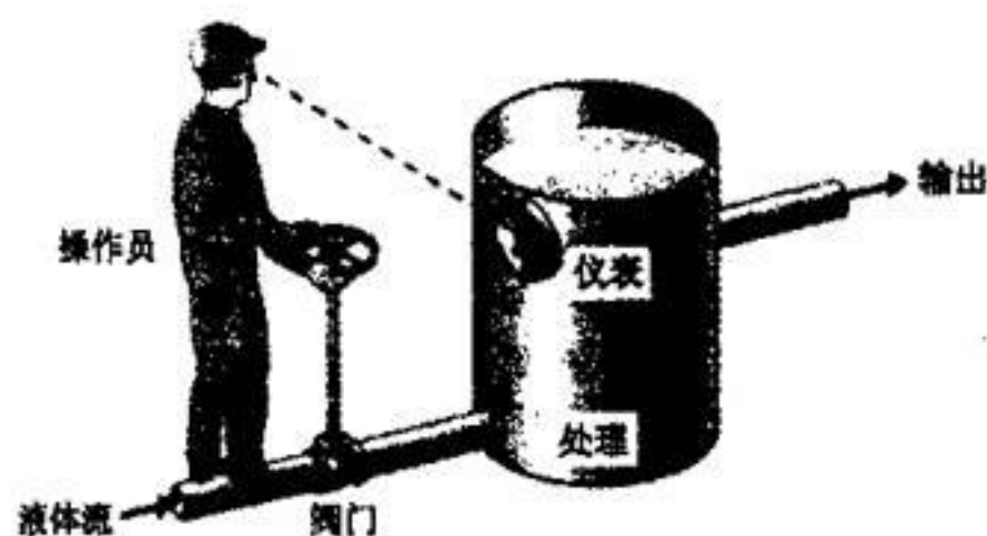
图题1 人工控制的阀门控制系统
