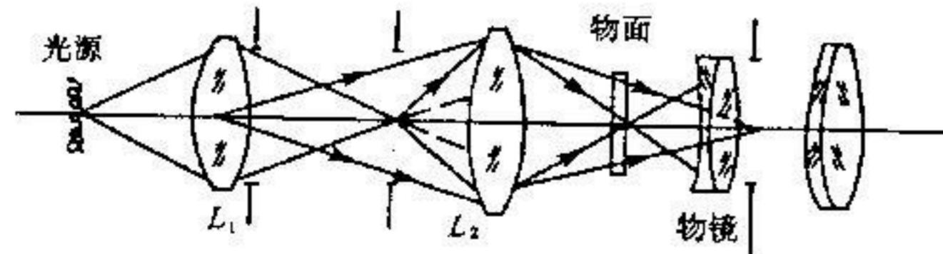
5. (20 分) 贝塞尔法测量透镜焦距的方法如图 4, 固定物面和像面之间的距离为  $L$  ( $L > 4$  倍的焦距), 移动透镜位置, 可以在像面上得到两次成像。测出两次成像时透镜移动的距离  $d$ , 便可计算焦距。请建立计算公式。
