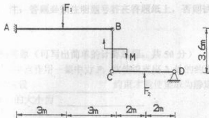
三. 计算题 (15 分) 作图示外伸梁的剪力图和弯矩图。
