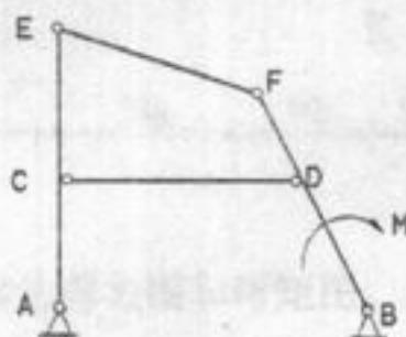
2. (5分) 试指出图示平面静定桁架中的零杆。
