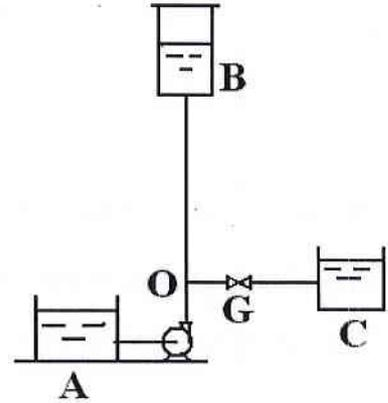
(1)、(14 分) 调小阀门 G 的开度, 使管路流向为  $O \rightarrow B$ , OB 支路流量为  $7.2 \text{ m}^3/\text{h}$ , 求此时泵的有效功率及 OC 支路的流量。
