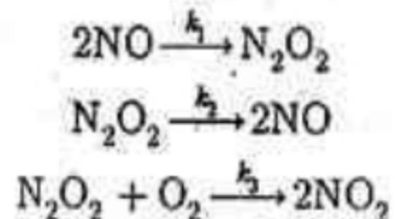
(1) 根据上述机理推导以  $\text{O}_2$  的消耗速率表示的反应速率方程。
