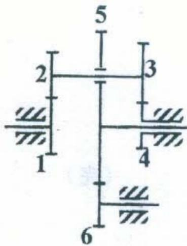
四. 一标准直齿轮减速传动, 已知:  $m=3\text{mm}$ ,  $z_1=30$ ,  $z_2=150$ , 齿宽系数  $\phi_d=0.9$ , 载荷系数  $K=2$ , 大齿轮轴的转速为  $n_2=192\text{r/min}$ , 小齿轮的许用接触应力  $[\sigma_{H1}]=500\text{MPa}$ , 大齿轮的许用接触应力  $[\sigma_{H2}]=450\text{MPa}$ , 试按齿面接触强度确定该齿轮传动所能传递的最大功率  $P$ 。 (20 分)
