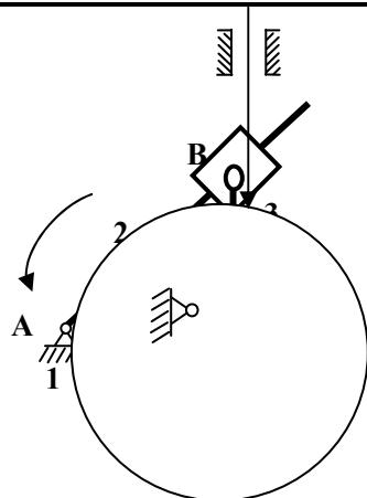
四、(15分,所有考生做)计算图示机构的自由度,若有复合铰链、局部自由度和虚约束,请指出。
