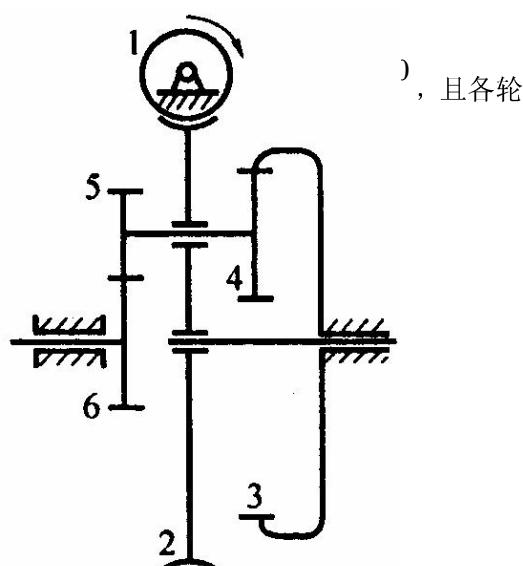
$z_1 = 2$ (右旋),  $z_2 = 60$ ,  $z_4 = z_6 = 40$ ,  $z_3 = 50$ ,  $z_5 = 20$ , 且各轮均为正确安装的标准齿轮, 各齿轮的模数相同。当轮 1 以  $900\text{r}/\text{min}$  按图示方向转动时, 求轮 6 转速的大小和方向。(全日制学术型, 15 分)
